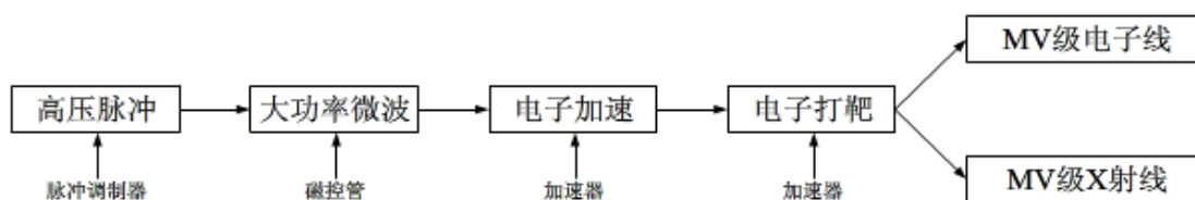
图 9-2 医用电子直线加速器的基本原理
