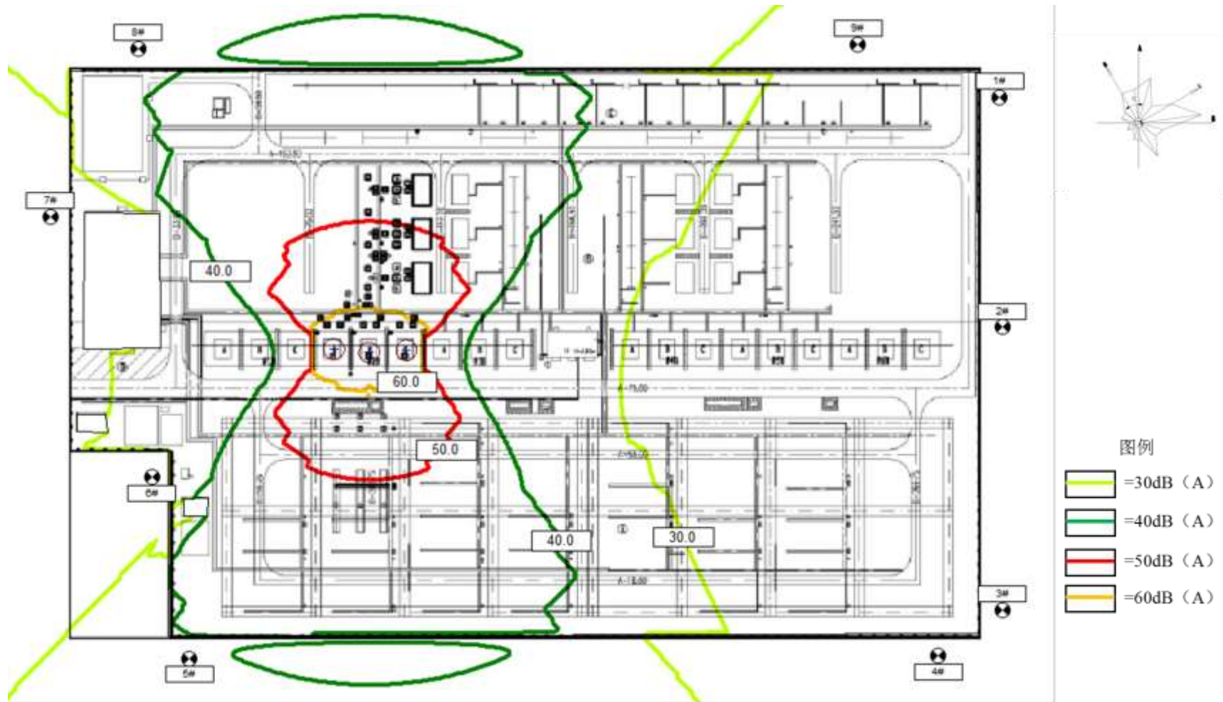
图 6-4 纵江变电站本期建设规模噪声贡献值等值线分布图(距地面 1.5m 高)
